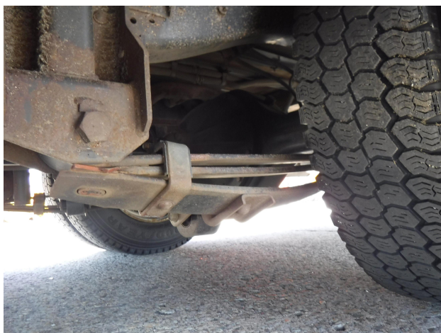
左右リヤリーフスプリング破損
