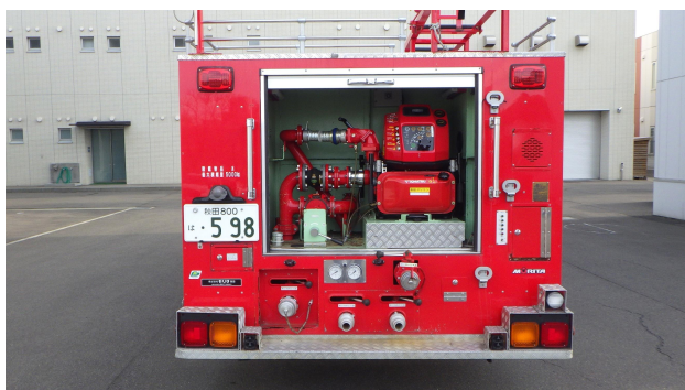
車体 後部ポンプ室内
