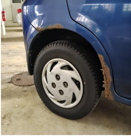
腐食が著しい箇所② 車両右後輪付近
