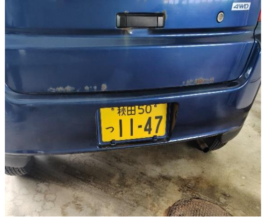
腐食が著しい箇所③ 車両バックドア下部
