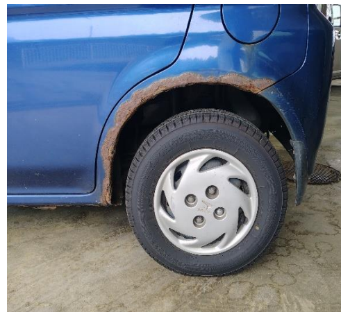
腐食が著しい箇所① 車両左後輪付近
