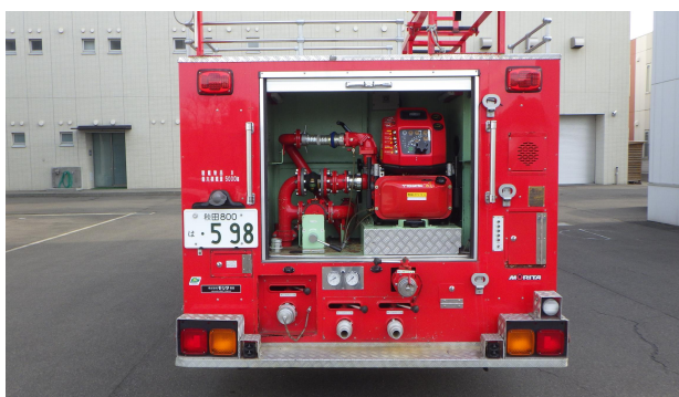
後面ポンプ室内
