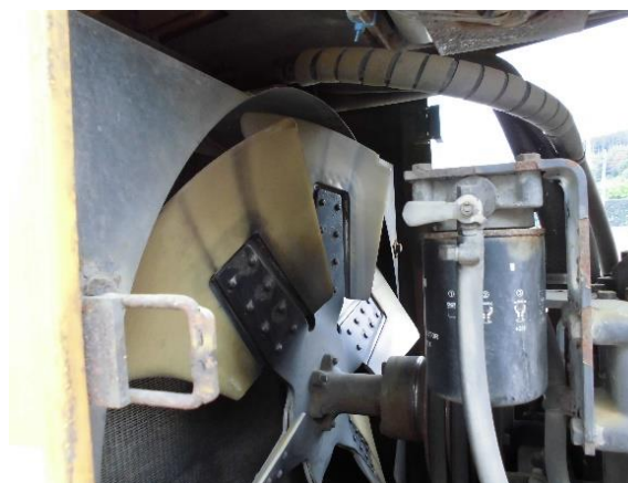
ファンガード破損（欠品）
