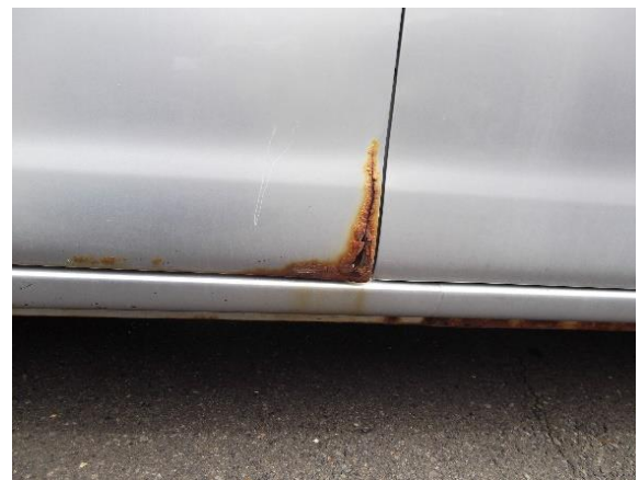
腐食が著しい箇所⑤ 車両左側部 助手席ドア下部
