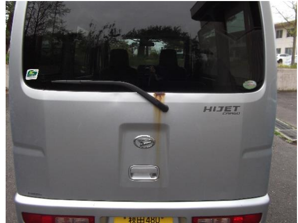
腐食が著しい箇所③ 車両後方ガラス下部
