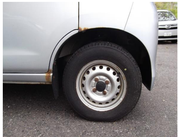
腐食が著しい箇所① 車両右前輪付近
