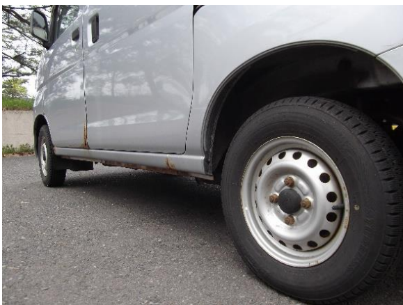
腐食が著しい箇所④ 車両左側部
