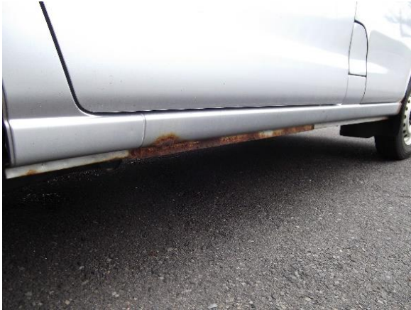
腐食が著しい箇所② 車両右側部
