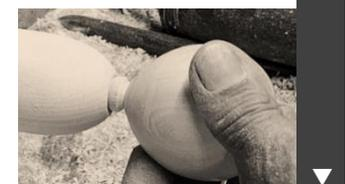
頭部の突起を回転による熱膨張を利用して差し込む。
