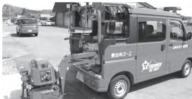
各班に配備される同型の小型動力ポンプ付軽積載車
