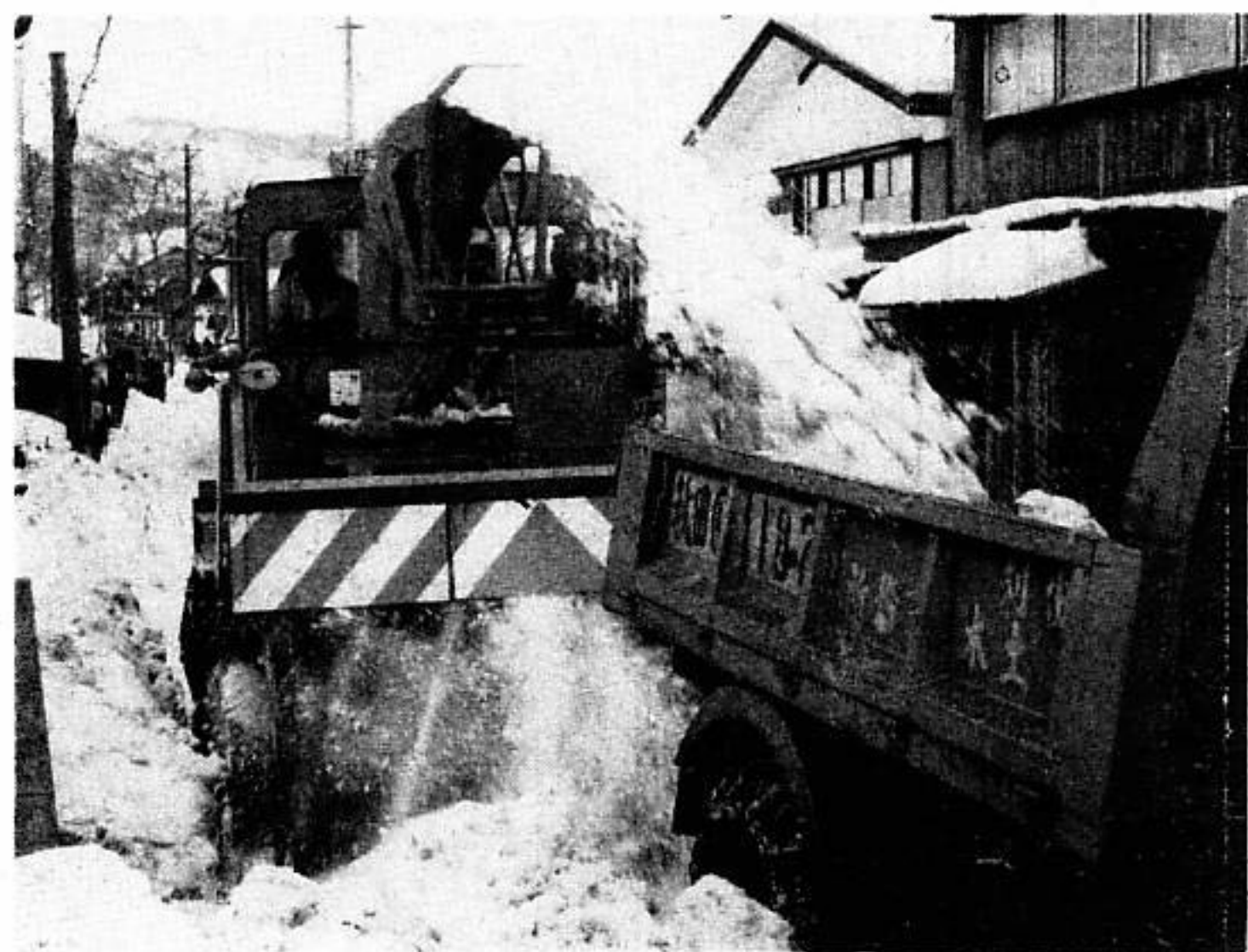
県と共同の排雪作業で威力を発揮するロータリー除雪車
