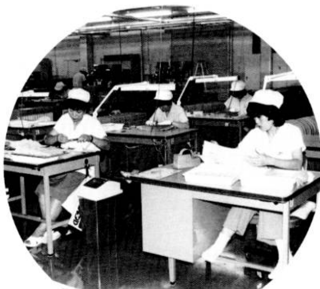
女子の仕事は生製品のチェックで、チェックされた250万個のコンデンサーが毎日出荷されている。
