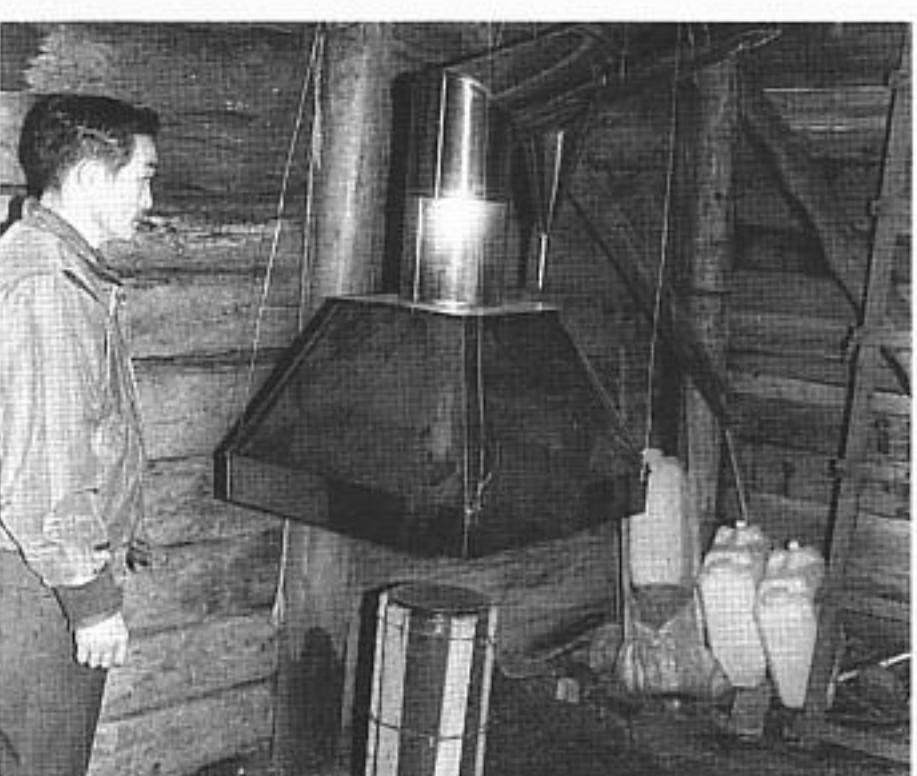
町の助成で導入した木酢液を回収する設備
