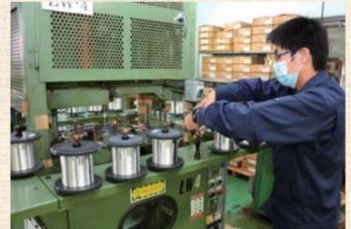
電線をよる(ねじり合わせる)より線機。写真は19本の銀線を1本により線加工する機械で、純銀を素材として扱う技術は世界的にも珍しい
