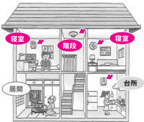
2階建て住宅の火災警報器設置例
