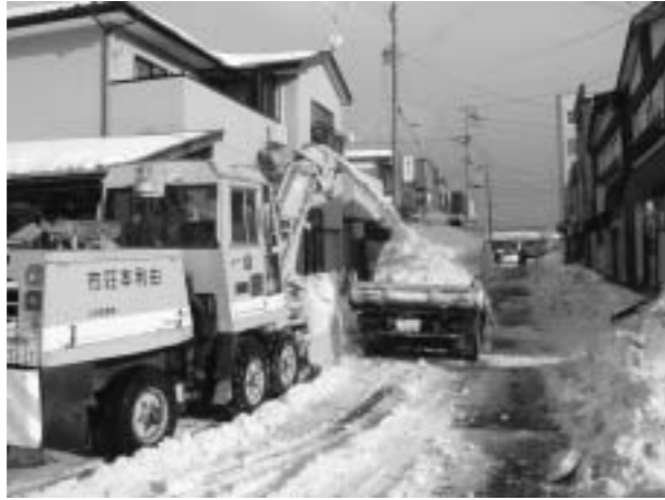
路肩にたまった雪を排雪する除雪車両
