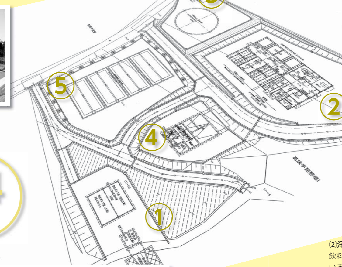
⑤天日乾燥床 てんぴかんそうしょう 濃縮槽で濃縮された泥を天日乾燥します。 RC造 4床 1床当たり 12メートル×25メートル×1メートル 300立方メートル
